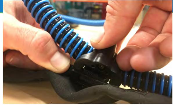
**7.** Hale el lazo de sujeción completamente a través de la ranura del lado izquierdo del punto de sujeción del arnés.
