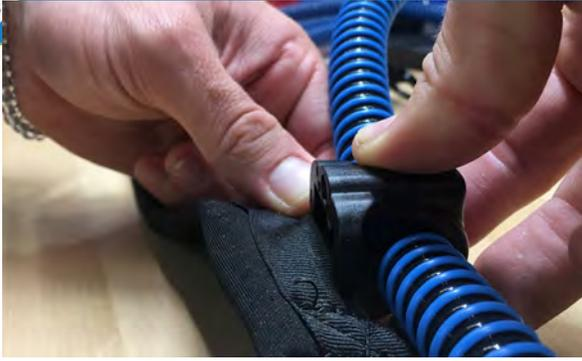
**6.** Inserte el borde del lazo de sujeción en la ranura del lado izquierdo del punto de sujeción del arnés.
