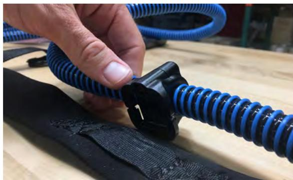
4. Alinee el punto de sujeción del arnés con el lazo de sujeción.
