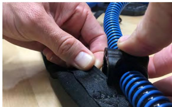
5. Inserte el borde del lazo de sujeción en la ranura del lado derecho del punto de sujeción del arnés.
