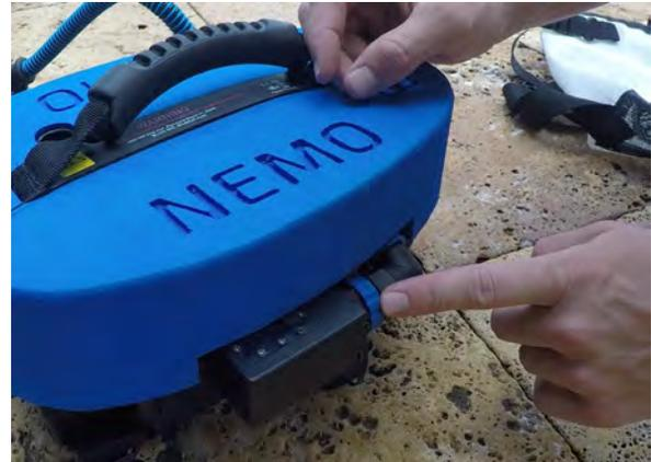
*Conecte el cable de alimentación al conector de la Batería (No.8)*
