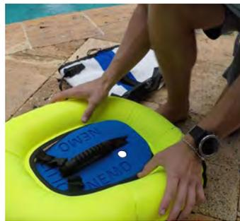
*Presione la parte trasera del flotador sobre la espuma*
