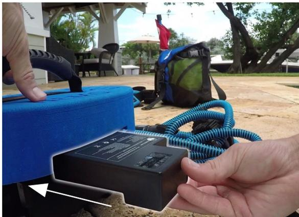
Inserimento della batteria nel vano batteria (n. 7)
